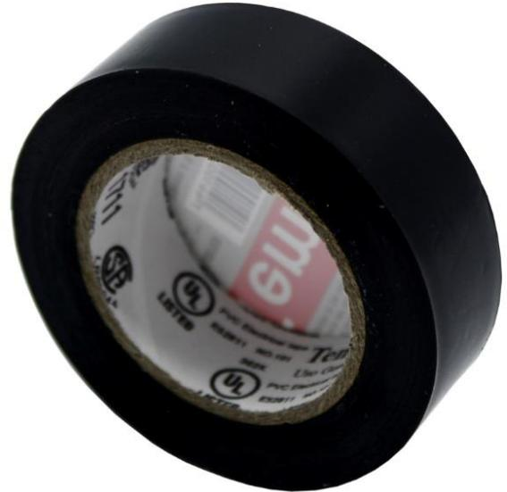
Tape eléctrico pvc, no es afectado por aceite, ácido, alcalis o humedad. Apropiado para ser usado a no más de 600V y no más de 80°C. La cinta eléctrica Temflex 1711 de uso general se utiliza específicamente para la reparación de forros de cables y para agruparlos y sujetarlos.
